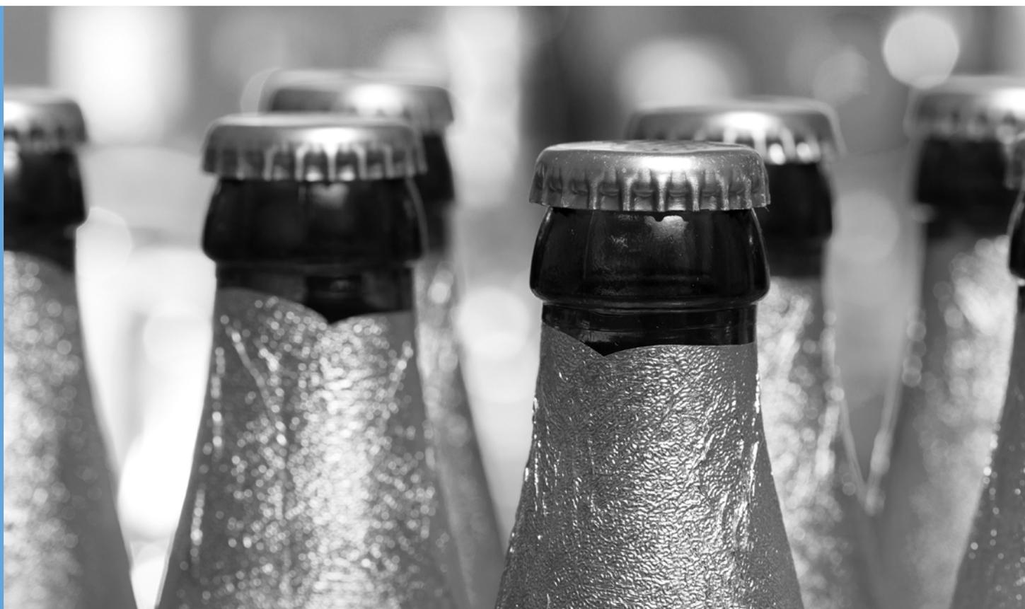
La lámina de Aluminio generalmente presenta un gofrado “vermicular” lo cuál vuelve más flexible y se ciñe mejor a los contornos del hombro y del cuello de la botella. La hoja de aluminio posee un espesor entre 8 y 15 micrones, su resistencia a la tracción debería ser como mínimo entre 12 y 15 N/mm.
