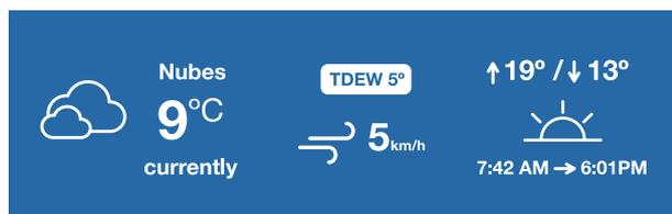
En esas condiciones no habrá condensación para superficies con una temperatura de 8°C.
