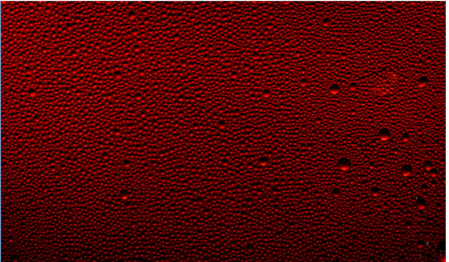
En el etiquetado de botellas de vidrio, donde la temperatura de llenado es inferior a  $15^{\circ}\text{C}$ , es habitual observar que se produzca el proceso de condensación en el envasado y almacenamiento del producto.
