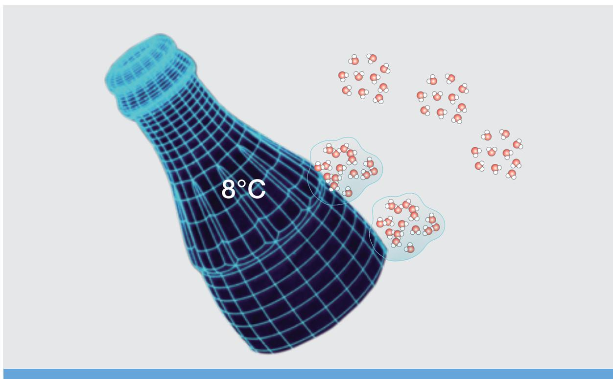
Para estas condiciones climáticas, si la temperatura del envase es aprox. de 8°C hay condensación. Cuánto mayor sea la diferencia entre el punto de rocío y la temperatura del envase mayor será la condensación.
