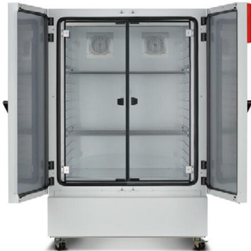
El objetivo es llevar a cabo estudios o ensayos para verificar el comportamiento de los adhesivos expuestos a situaciones de condensación. Para esto se utilizan equipos diseñados para simular condiciones controladas de temperatura y humedad relativa en su interior, denominados cámaras climáticas.
