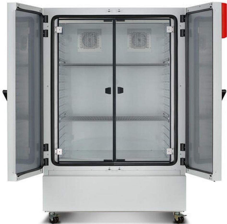
**Las Cámaras climáticas son equipos diseñados para simular condiciones controladas de temperatura y humedad relativa en su interior.**
