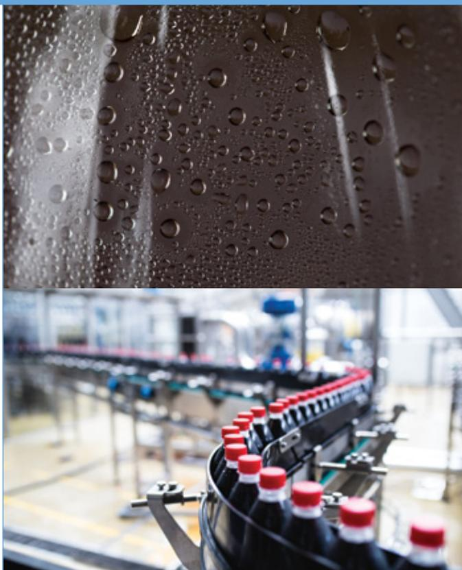
La relación entre estos dos factores (la temperatura y la humedad relativa) determina la temperatura de rocío. Este es el punto (Dew Point) en el cual el aire, en contacto con una superficie de menor temperatura (envase frío), comienza a condensar, iniciando un cambio de estado pasando de ser un gas para transformarse en un líquido.
